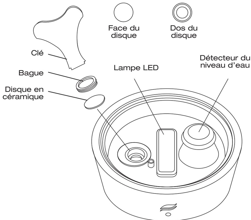
**Astuce :** Si le disque ne se retire pas immédiatement, appuyez légèrement dessus avec le doigt pour le débloquer.
